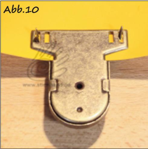
Die Projekt-Kante wieder in das Schloss-Oberteil stecken, die geschnittenen Schlitze liegen exakt unter den Schlitzten der Schnalle.
